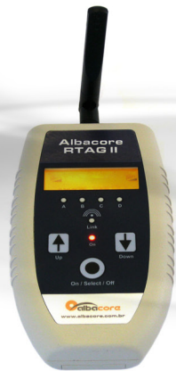
RTAG II Permite realizar testes de "ranging" (alcance) em campo.
